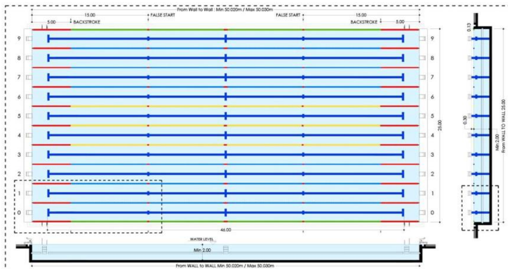
Obrázek 53 – Ukázka řešení plaveckého bazénu 50 x 25 m
